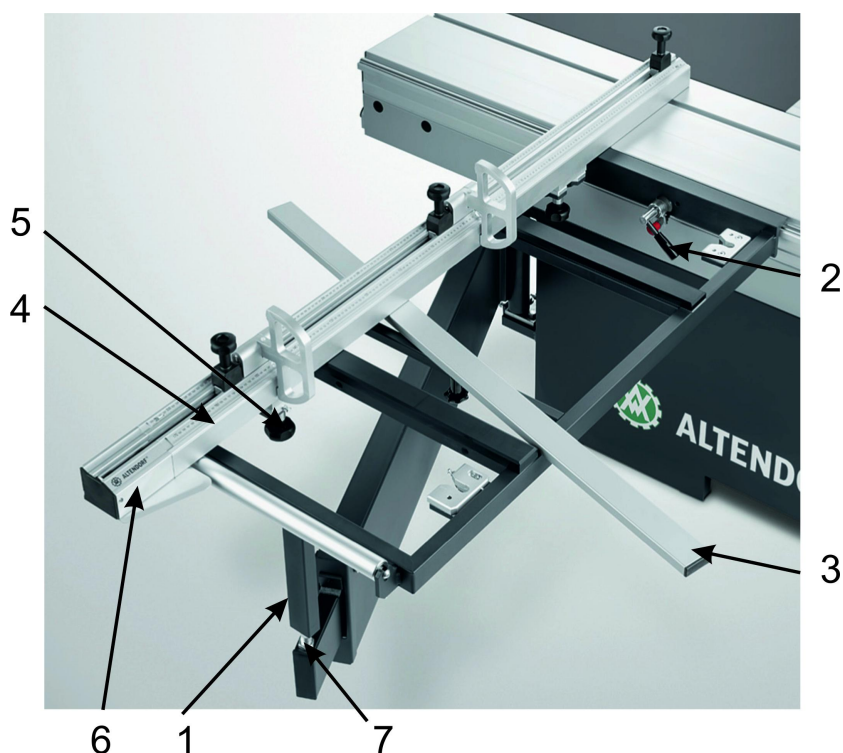
Joon. 5-13 Ristkelgu montaaž
