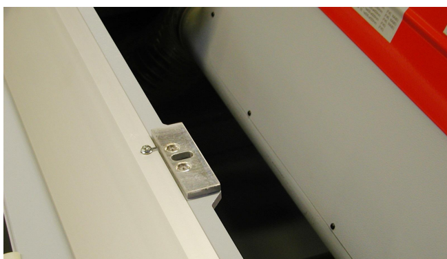
[1] Keerake keskmine kinnituskrugi kinni. [2] Kontrollige alumiste jooksurullide seadistust.
